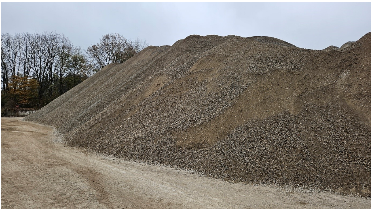
Abbildung A 2: Foto Haufwerk Betonbruch am 13.11.2024
